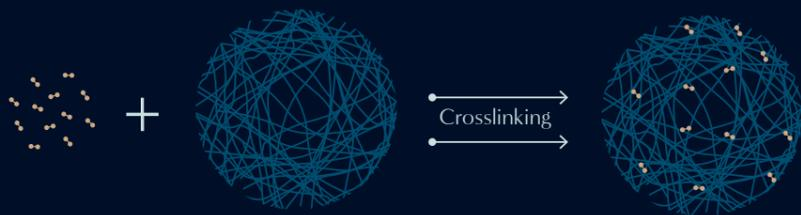
Die Quervernetzung unter inerte Atmosphäre erfolgt unter Einsatz geringer Mengen BDDE und führt zur Umwandlung der Lösung in ein Gel.
